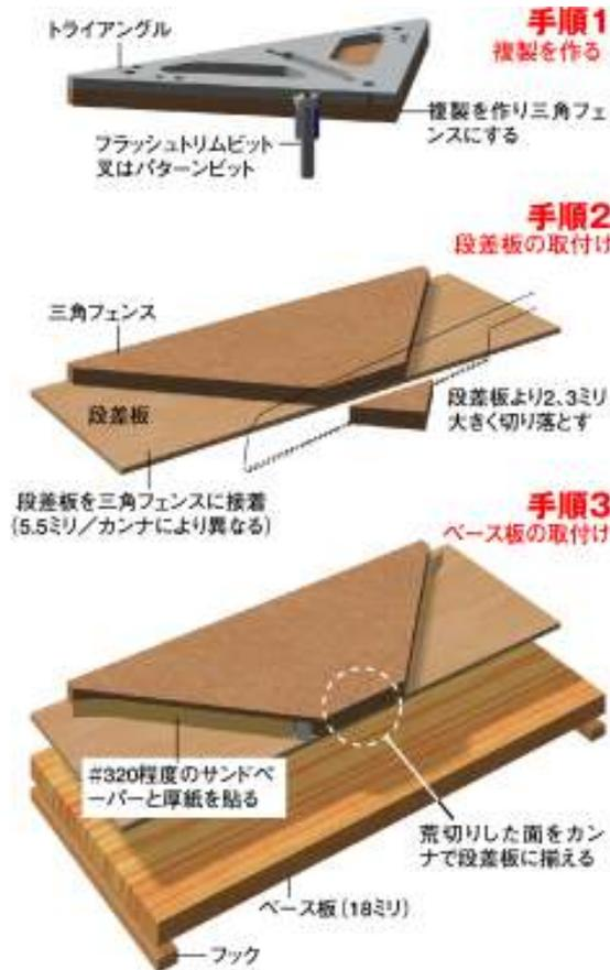
左図が全体の製作手順だ。一通り見てほしい。手順1では、まずトリアングルで複製の三角フェンスを作る。写真1は加工中の写真だ。フラッシュトリムビットのベアリングがトリアングルに沿いながら2、3mm大きく荒切りした分を削り取り、複製を作っている。
