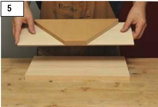
手順3、写真5（左）でベース板を接着する。ここでは多少のずれが生じて大丈夫。ベース板で全体の剛性を高めることとカンナが前後移動する“廊下”を設けるのが目的だ。フックも接着する。フックの高さは10mm、幅15mm程度。削り台両端に取付ける。
