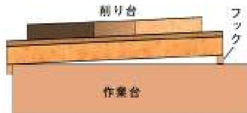
材を加工する際注意することがある。横に倒したカンナを前後に動かして削る際、刃を材に押し当てすぎてカンナが傾かないようにすること。また、刃の出方がカンナ底面と平行でないと、削る面がななめになるのでその点にも注意する。この削り台で様々な額縁を作り、腕を磨いてほしい。
