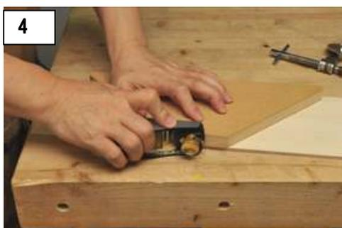
写真4で三角フェンスの出っ張り部分をカンナがけし段差材にあわせる。
